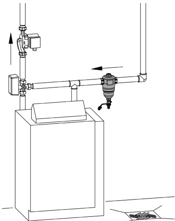
Abb. 4: Installationszeichnung Schlammabscheider
