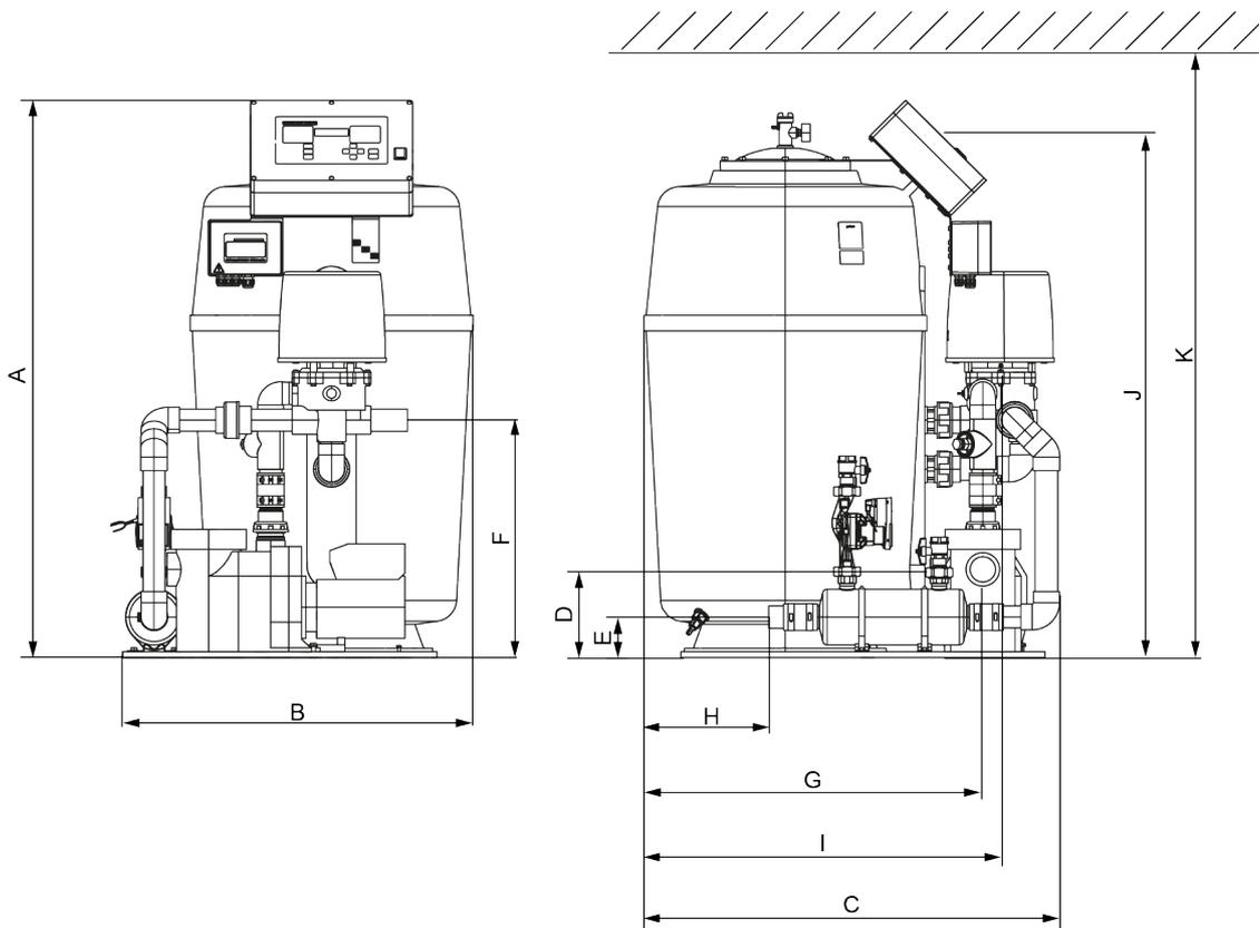
Abb. C-4: Maßzeichnung Filteranlage GENO-mat F 600 AK; WS-Eco
