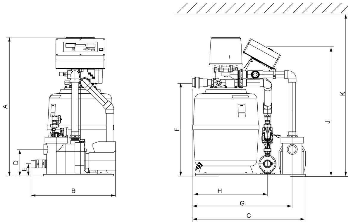
Abb. C-3: Maßzeichnung Filteranlage GENO-mat F 500 AK; WS-Eco
