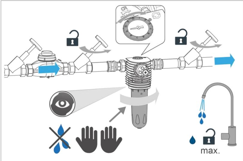
9. Reinigen Sie die Filterglocke mit klarem Wasser.
