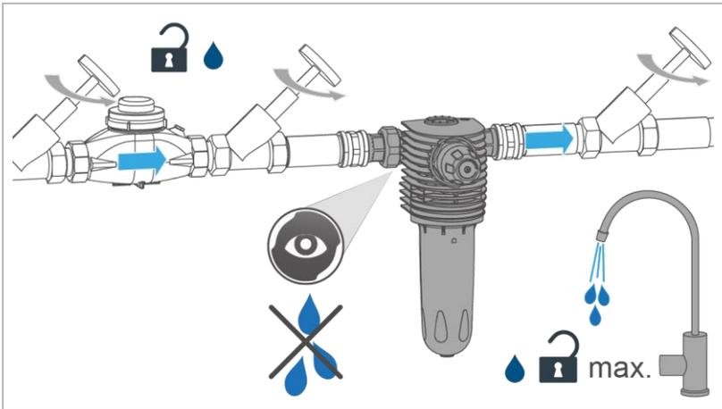
4. Öffnen Sie die Absperrventile.
