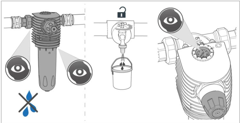
1. Prüfen Sie die Installation auf Dichtheit und Funktion.
